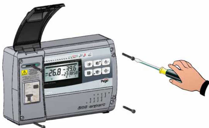
Fig. 2 : Svitare le 4 viti di fissaggio del frontale della scatola.
